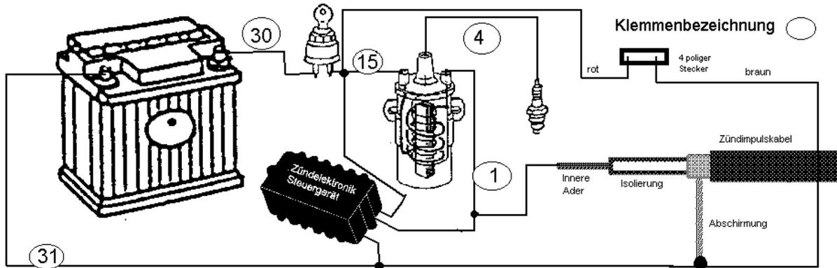
Auf dem Bild sehen Sie den Anschluß der Versorgungsspannung (rotes und braunes Kabel an 4pol Stecker) und des Zündimpulskabels.
